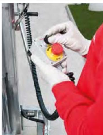
La commande amovible permet d'actionner la plate-forme même depuis le sol.
