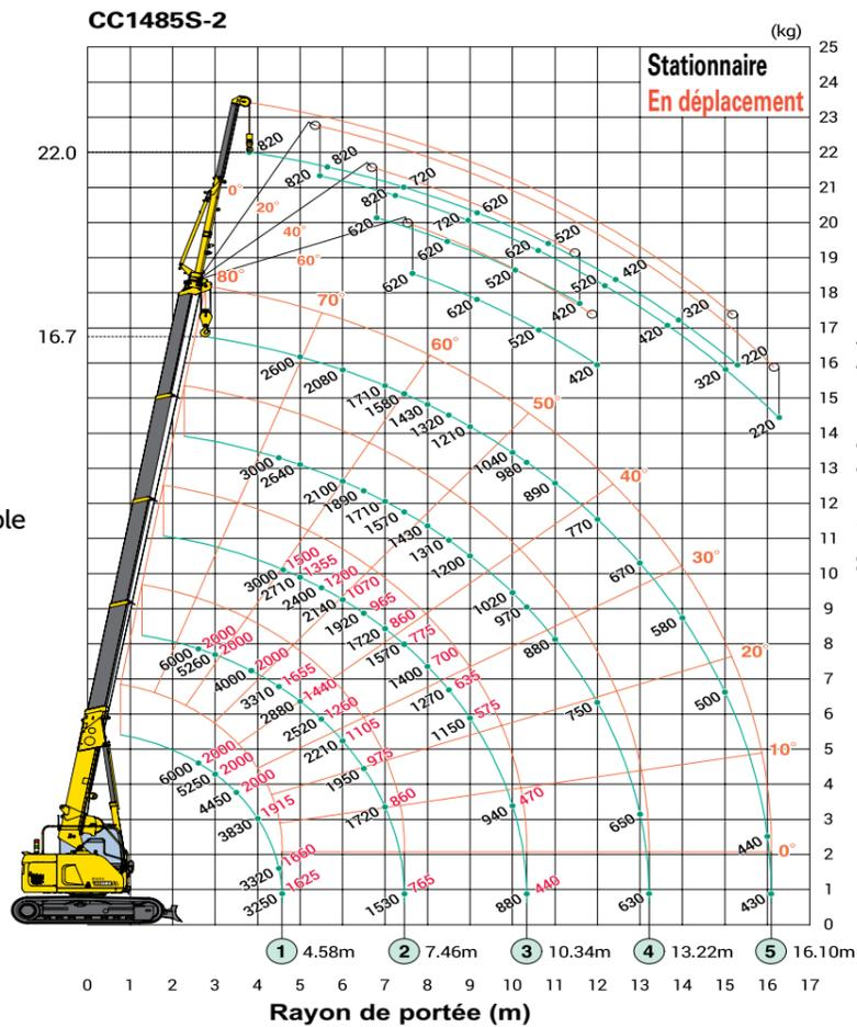
Le diagramme de portée montre la charge nominale totale, incluant la déformation de la flèche et de la fléchette/jib.
