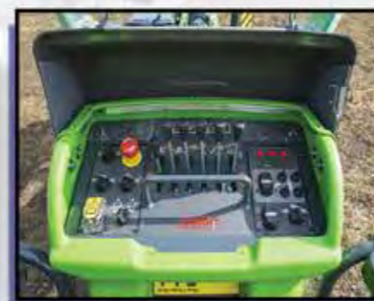
POSTE DE COMMANDE PANIER
