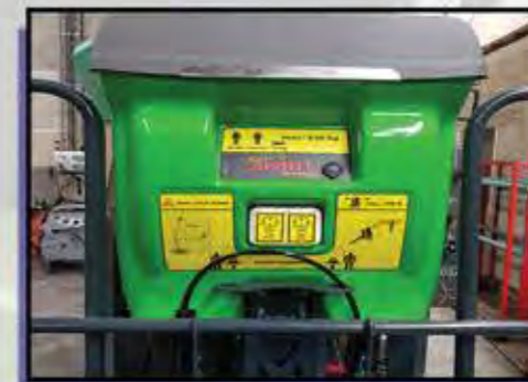
PRISES 220V et 12 V. ARRIVEE AIR/EAU DANS LE PANIER
