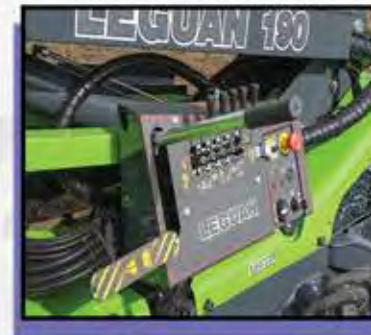
Pompe de secours manuelle
