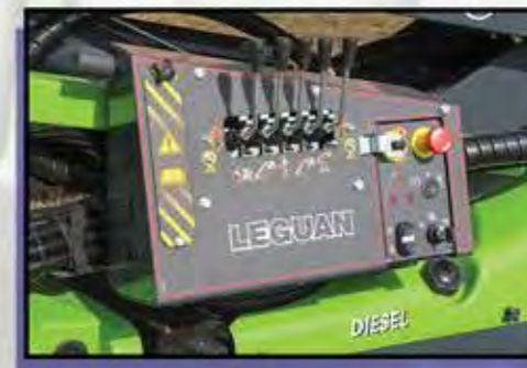
POSTE DE COMMANDE BAS
